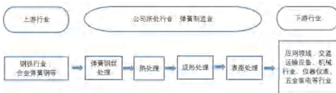
弹簧一般用弹簧钢制成，产业链上游主要涉及钢铁行业；弹簧的下游应用行业非常广泛，从各类运输设备、大型机械到各类日常家电及生活用品，各种机器中均装有弹簧。不同行业和产品对弹簧的尺寸、弹性、抗腐蚀性等诸多指标均有不同要求。其中，航空航天、轨道交通、汽车整车、工程机械、机器人等应用领域由于对弹簧产品的使用环境、性能指标有较为苛刻的要求，通常只有较强技术实力的弹簧企业才能成为其合格供应商。
