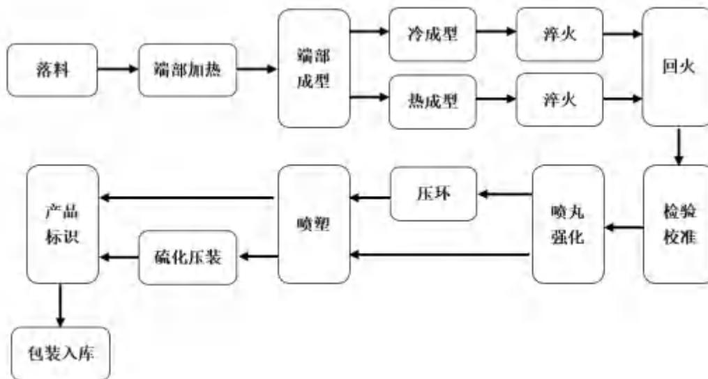
稳定杆的制造方法可分为冷成型和热成型。冷成型是稳定杆棒材通过弯管机弯制成型，成型后再进行热处理，优点是能快速配合客户不同线径不同形状调校，适合小线径且形状简单的产品；热成型是稳定杆棒材经过加热后在数控热成型机上锻压成型，优点是成型效率高，不受产品形状、线径的约束，产品稳定性、一致性高。
