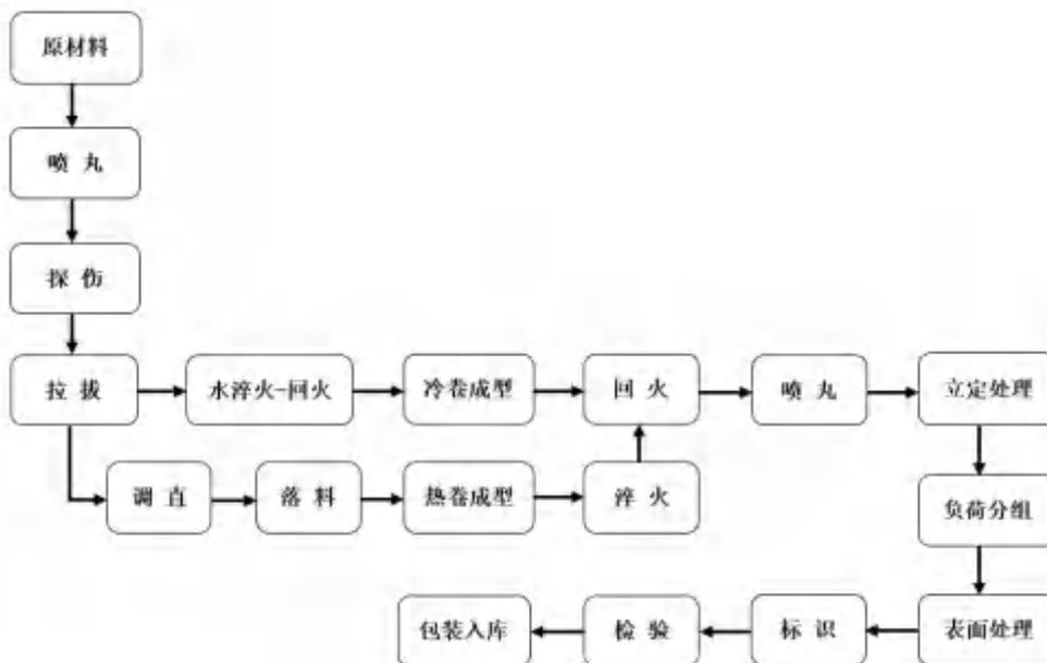
悬架弹簧、制动弹簧的成型工艺可分为冷成型和热成型。冷成型是在常温下卷制弹簧，优点是可减少热处理中的弹簧变形，提高成品率，并减少加热过程中材料表面引起的脱碳；热成型是在材料加热的状态下卷制弹簧，主要应用于线径较粗的弹簧，可使大线径的材料比冷卷更易于卷绕。
